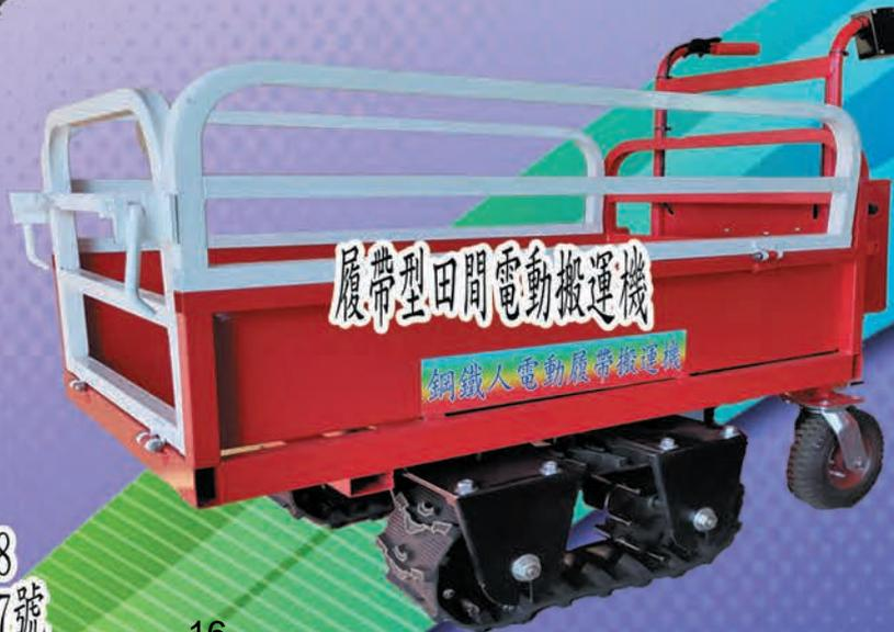
履帶型田間電動搬運機
