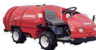
SSV5045F/553F 藥液容量:500公升 馬力:20ps/23ps 風量:430/520立方公尺 電動動力方向盤 傳動軸直接式風鼓
