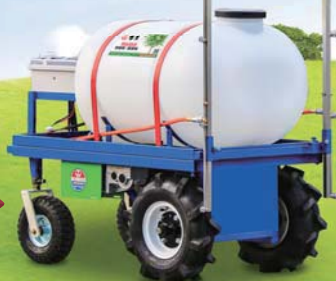
★ TW100 自行研發製造 乘坐式電動噴霧機
