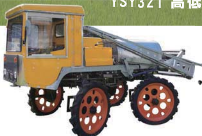
YSY321 高架桿式噴霧機(23HP) LY511 高架桿式噴藥機(久保田三缸26HP) (冷氣為選配加裝)
