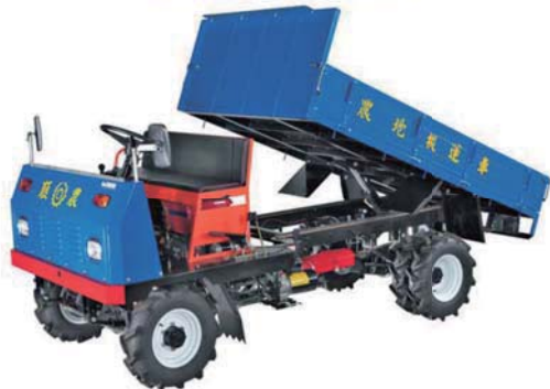
SN-140 四輪傳動+油壓傾卸車斗
