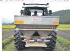
(共用式)化學(造粒)+雞屎(有機)肥-下孔出料型500、1020L、1900L 施肥桶
