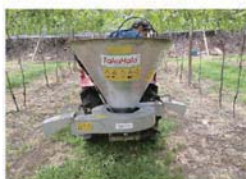
化學(造粒)肥-側孔出料型(小孔)300、500 施肥桶
