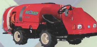
3S-C522[藥液吐出量63L/min]
