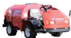
VRC405SX 引擎+泵浦+收管一體型 自動排列式收管機構 助走機構 藥管長度:200m 泵浦:活塞式 最大壓力:50kgf 引擎:HONDA GX200
