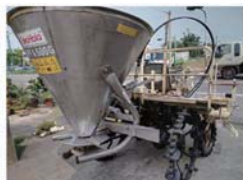
化學(造粒)肥-側孔出料型(小孔)300、500 施肥桶
