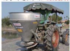
(共用式)化學(造粒)+雞屎(有機)肥-下孔出料型500、1020L、1900L 施肥桶
