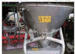
施肥桶改裝油壓缸控制
