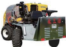
YSY316 自走鼓風式噴藥機 (16HP, 550mm風機, 360L)
